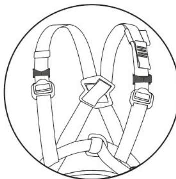
Рис. 5. Правильная установка скобы на ленте
