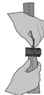
Рис. 4. Продевание ленты привязи
