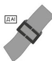
Рис. 5. Правильная установка скобы на ленте
