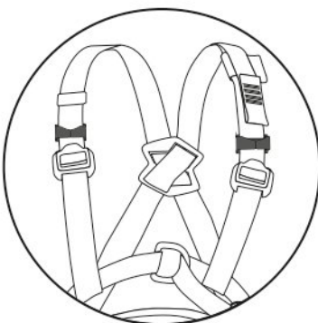
Рис. 5. Правильная установка скобы на ленте
