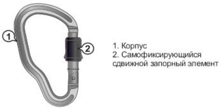
Рис. 1. Общий вид и составные детали соединительных элементов
